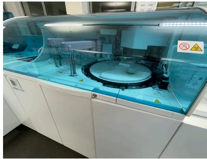
Abb. 2: Vollautomatisierte, turbidimetrische Bestimmung von Calprotectin am Cobas c701 (Roche)
