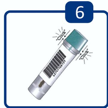
Teststab in das Proberröhrchen stecken und dieses somit verschließen. Nach einem hörbaren „Klick“ ist das Proberröhrchen ordentlich verschlossen. Probenahme **nicht** wiederholen!
